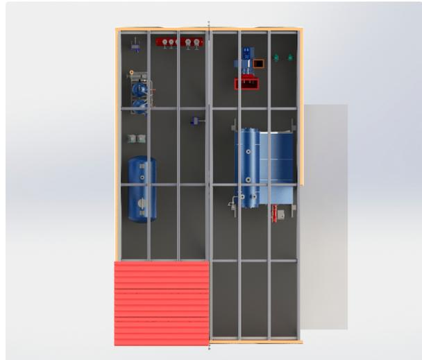
Модульные котельные установки (МКУ) являются автономными источниками теплоснабжения и включают в себя полный комплекс оборудования для выработки тепловой энергии. МКУ поставляются в полной заводской готовности, оборудование размещается в транспортабельных контейнерах, что значительно упрощает доставку и монтаж в любом месте (городе, производственной площадке).
